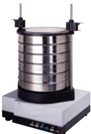
Système de tamisage automatique utilisé dans les laboratoires pour l'étude granulométrique des sols.
